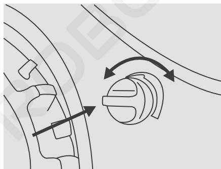
Chcete-li nastavit výšku sečení, stiskněte a otočte regulátor výšky sečení požadovaným směrem:
