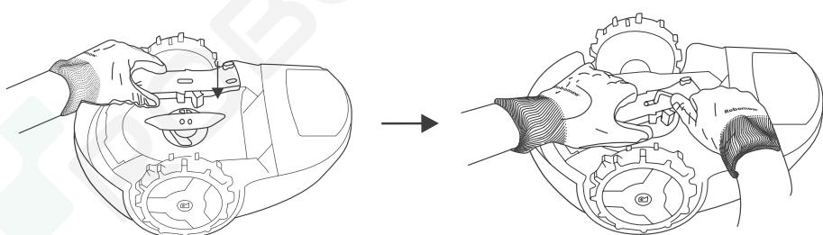
4. Použijte dodaný inbusový nástroj (dodává se s náhradním nožem) k odšroubování šroubů a zároveň podržte nůž pomocí nástroje RoboTool.
